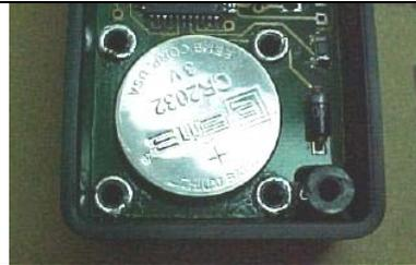
4. Remonter le couvercle de pile et revisser les 4 vis. Ne pas trop serrer les vis. Attention de ne pas endommager les pas de vis dans le circuit imprimé.
